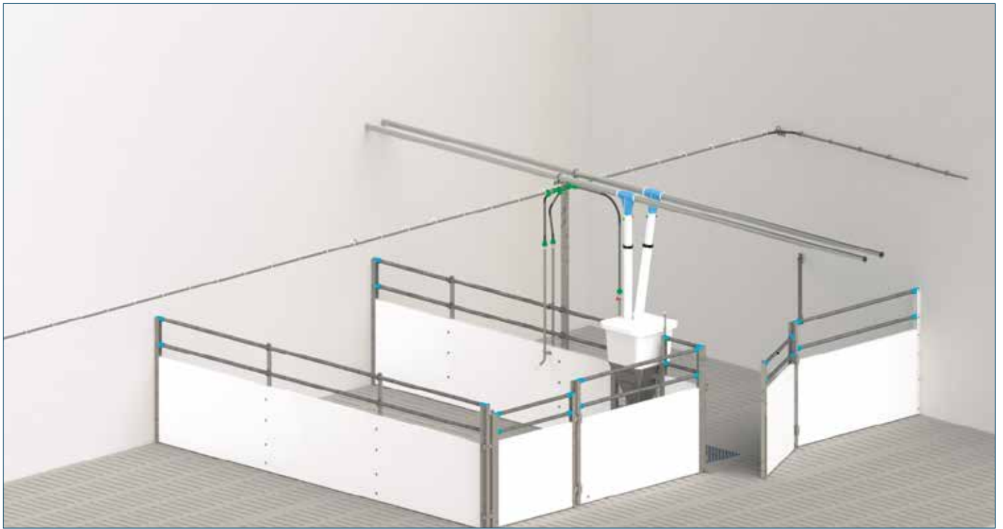
Mastbucht mit einem Star-Feeder-Automaten S-Flex, Trennwandbeschläge Typ 5, Vorderfront 1,10 m hoch, Drehtor 1,00 m hoch. Abstützung der Vorderfront mit einer Diagonalstrebe. Ein Profilstützpfeiler (3) ist durch einen V2A-Winkelpfeiler (5) mit Stabilisationsrohr ersetzt worden.
