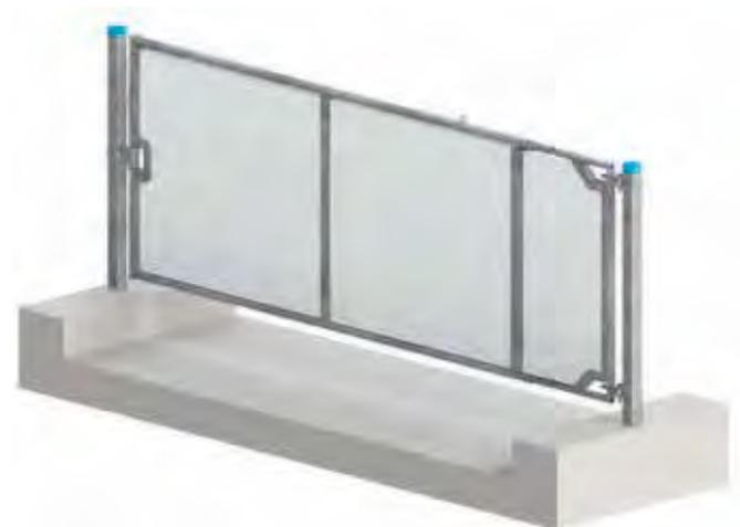
Die Buchtentüren sind senkrecht verstrebt und werden auf Maß gefertigt. Drehpunktseitig werden stabile Augenschrauben M20 eingesetzt. Verriegelt werden die Buchtentüren mit einem stabilen Hub- / Drehverschluss. Ohne Hängen, Verschlussaufnahme und Befestigungsmaterial.
