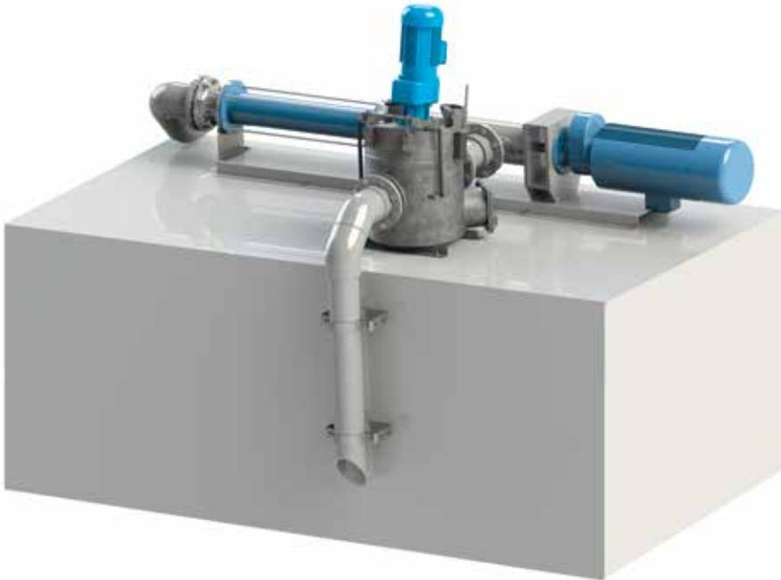
Zum Schutz Ihrer Anlagen und der darin enthaltenen Pumpaggregate kann das leistungsfähige Zerkleinerungssystem DuraCut eingesetzt werden. Störstoffe werden pumpfähig zerkleinert. Die Gefahr der Verstopfung der Pump- und Rohrleitungssysteme wird von vornherein vermieden und Beschädigungen nachgeschalteter Aggregate werden auf ein Minimum reduziert.
