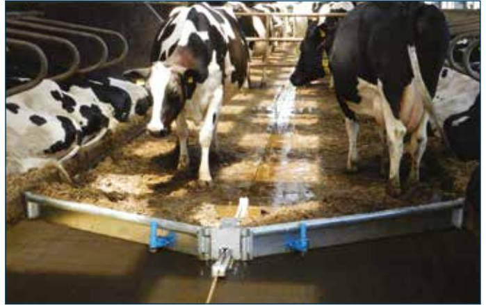
Um den Faltschieber auf kürzestem Weg von der Rücklauf- in die Räumstellung zu bringen, befindet sich am Ende der Schieberbahn eine flach liegende Kulisse, auf die der Schieber heraufgezogen wird. Seitlich an den Schieberblättern angebrachte Führungsbolzen gleiten an der Kulisse entlang und bewirken so ein Öffnen des Schiebers.
