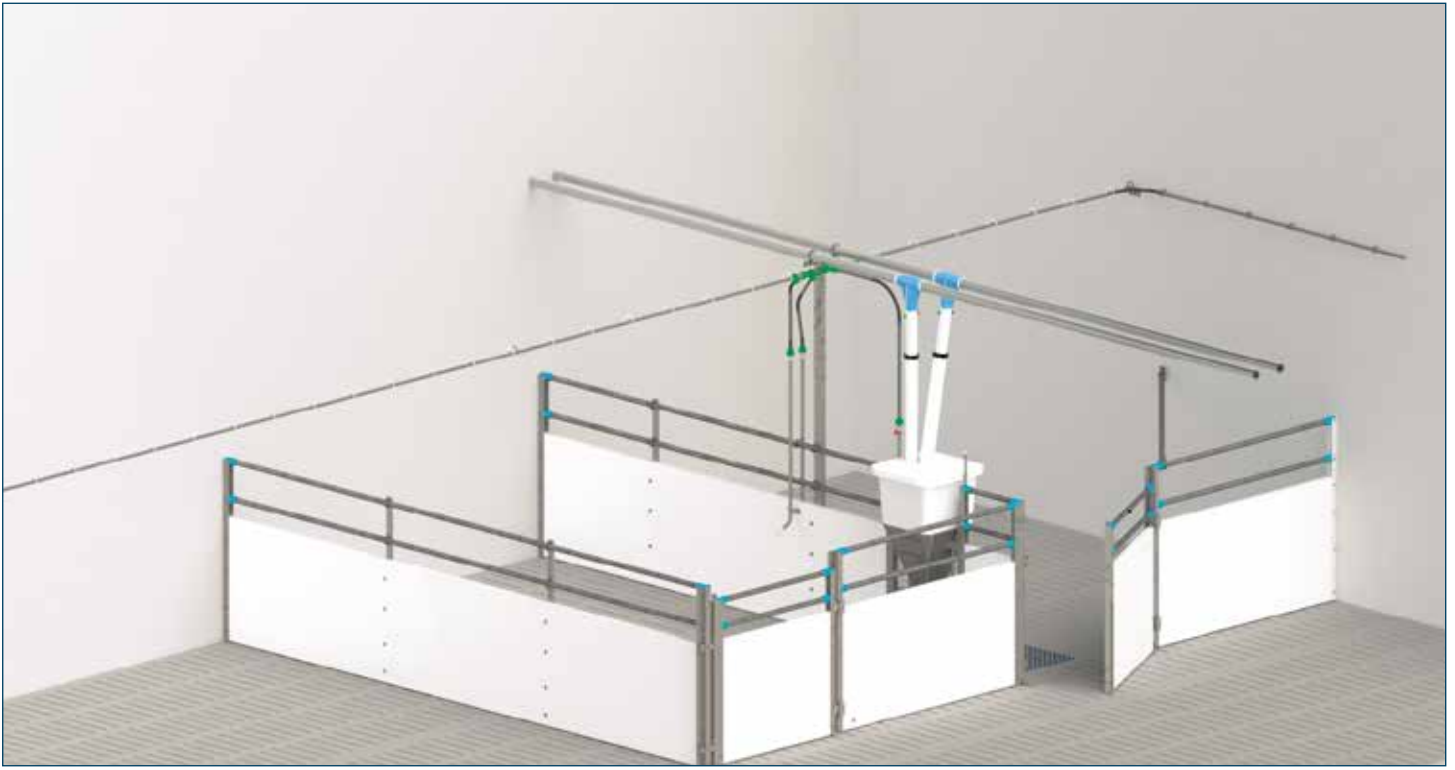
Mastbucht mit einem Star-Feeder-Automaten S-Flex, Trennwandbeschläge Typ 5, Vorderfront 1,10 m hoch, Drehtor 1,00 m hoch. Abstützung der Vorderfront mit einer Diagonalstrebe. Ein Profilstützpfosten (3) ist durch einen V2A-Winkelpfosten (5) mit Stabilisationsrohr ersetzt worden.
