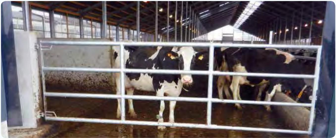
Die Buchtentüren sind waagrecht verstrebt und längenverstellbar. Drehpunktseitig werden die Gitter mittels stabilen Augenschrauben M20 aufgehängt. Die Aufhängung ermöglicht ein leichtes Ausjustieren der Gitter. Verriegelt werden die Gitter mit einem stabilen Hub- / Drehverschluss. Ohne Hängen, Verschlussaufnahme und Befestigungsmaterial.
