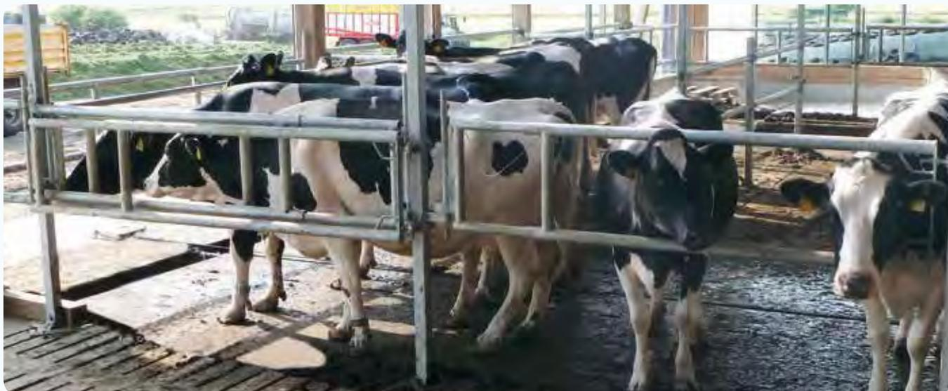
Die Absperrgitter und -pforten sind waagrecht verstrebt und langenverstellbar. Drehpunktseitig werden die Gitter mittels stabilen Augenschrauben M20 aufgehangt. Die Aufhangung ermoglicht ein leichtes Ausjustieren der Gitter. Verriegelt werden die Gitter mit einem stabilen Hub-/Drehverschluss. Ohne Hangen, Verschlussaufnahme und Befestigungsmaterial.
