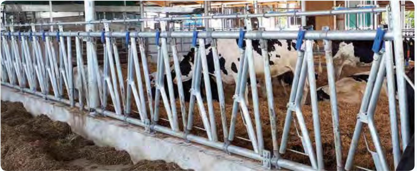
Das Selbstfangfressgitter SL 86 mit einer Gitterhöhe von 86 cm eignet sich insbesondere für Jungvieh oder auch für Stallerweiterungen mit vorhandenen 86 cm hohen Fressgittern. Die besondere Aufhängung der Kippstrebe gibt den Tieren noch mehr Bewegungsfreiheit am Futtertisch. Ausgerutschte Tiere können problemlos aus dem Fressgitter befreit werden.
